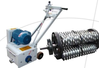
Fresadora de Piso de Concreto
